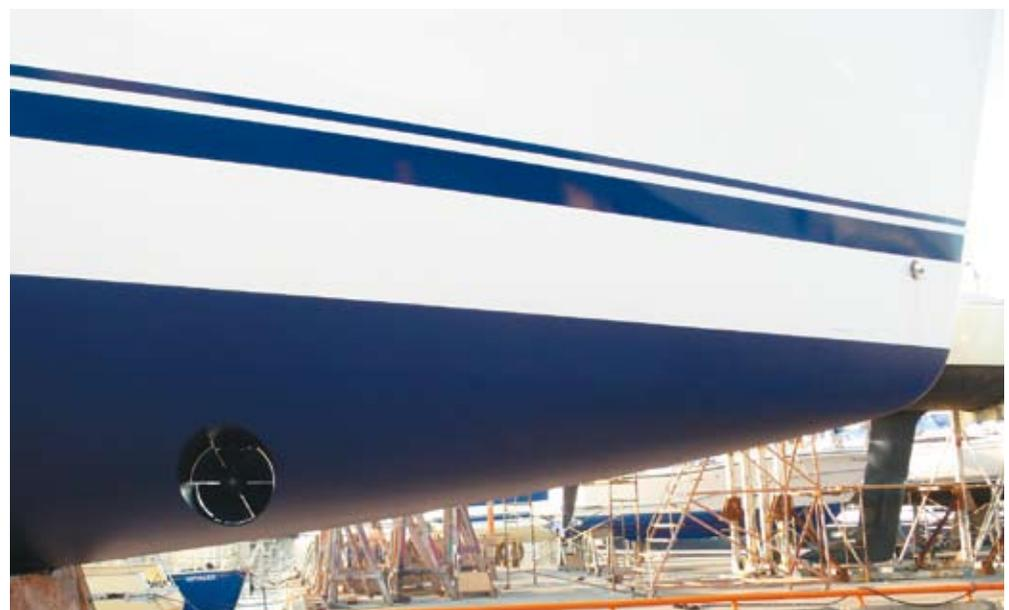
La hélice se debe instalar lo más a proa posible y sumergida entre 1 y 1,50 veces el diámetro del túnel
