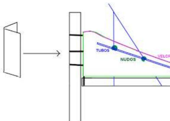
Dado que al coser estos tubos la altura de la funda se ha reducido procedo a sujetarla por debajo de la vela y no como iba antes por debajo de la botavara, utilizando los mismos clips y sin coserla, ya que así ventilará y drenará la humedad y el agua fácilmente.
