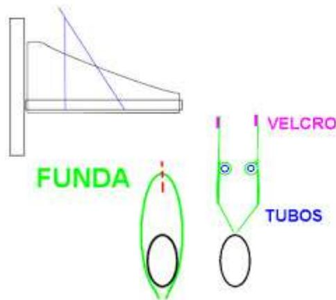
A 10cm más abajo del velcro he hecho un pliegue en cada una de las dos piezas, casi igual de largo que el corte, para meter en él una tubería de plástico, de 3cm de diámetro y casi 5m de largo.
