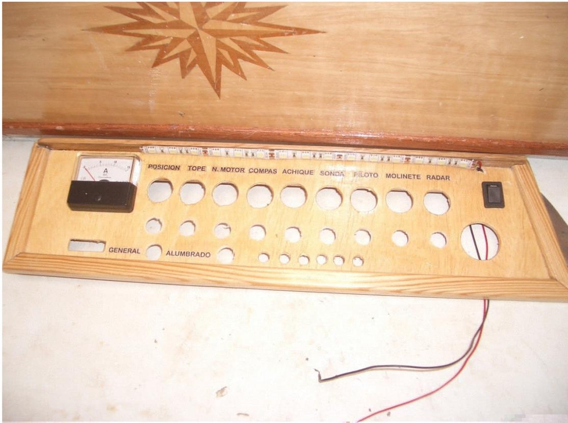
Preferí el sistema de interruptor con luz (led) y fusible frente al magneto térmico porque es el sistema más barato.
